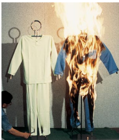
衣服（パジャマ）燃焼実験（同時着火1分経過の状況）
